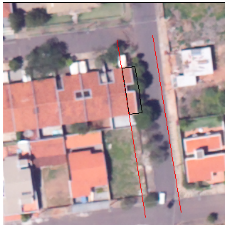
Figura 11: Obstrução detectada no espaço-objeto e projetada para a imagem.
